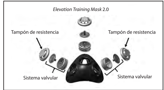
Figura 1. Tapones de resistencia y sistema valvular de la Elevation Training Mask 2.0.
