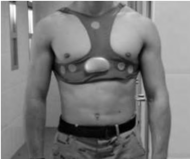
Figura 2. Dispositivo Nuubo® con arnés y electrodos.
